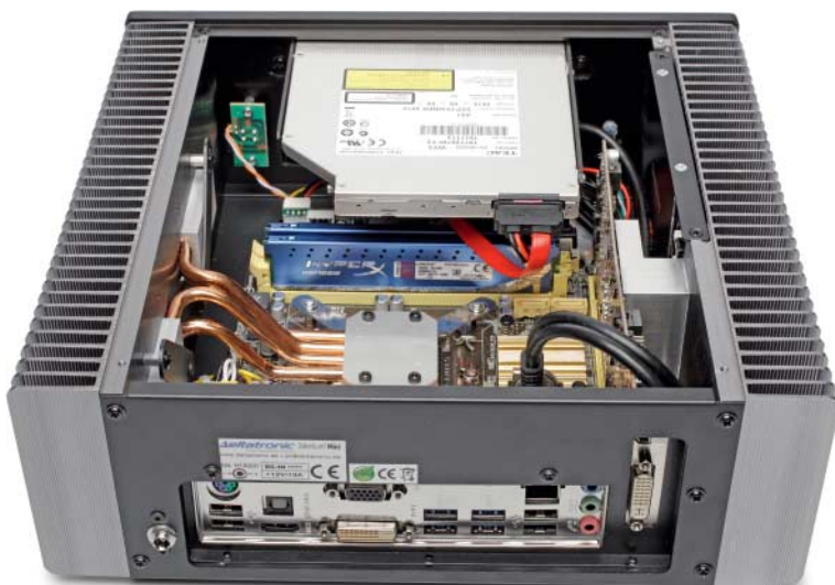
Prozessor und Grafikkarte geben ihre Wärme im PC Silentium! Mini direkt ans Gehäuse ab.
